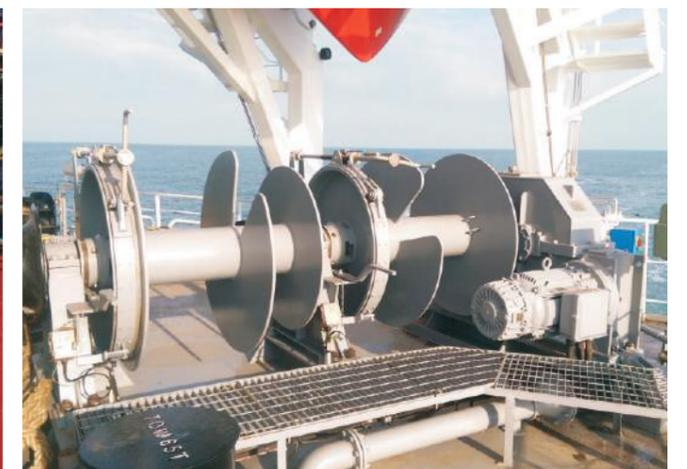
38800DWT散货船用125KN电动绞车
