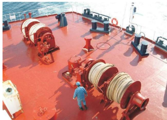
76000T 散货船147KN 液压系泊绞车
