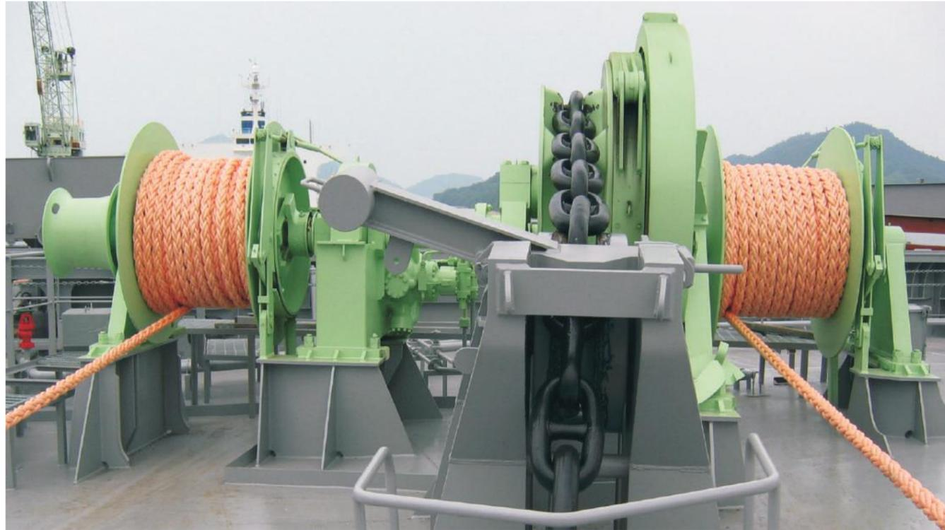
76000T散货船用的Φ76液压锚机
