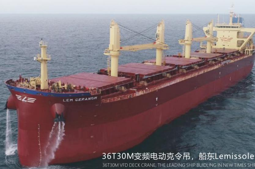
36T30M变频电动克令吊, 船东Lemissoler在新时代船厂首制船
