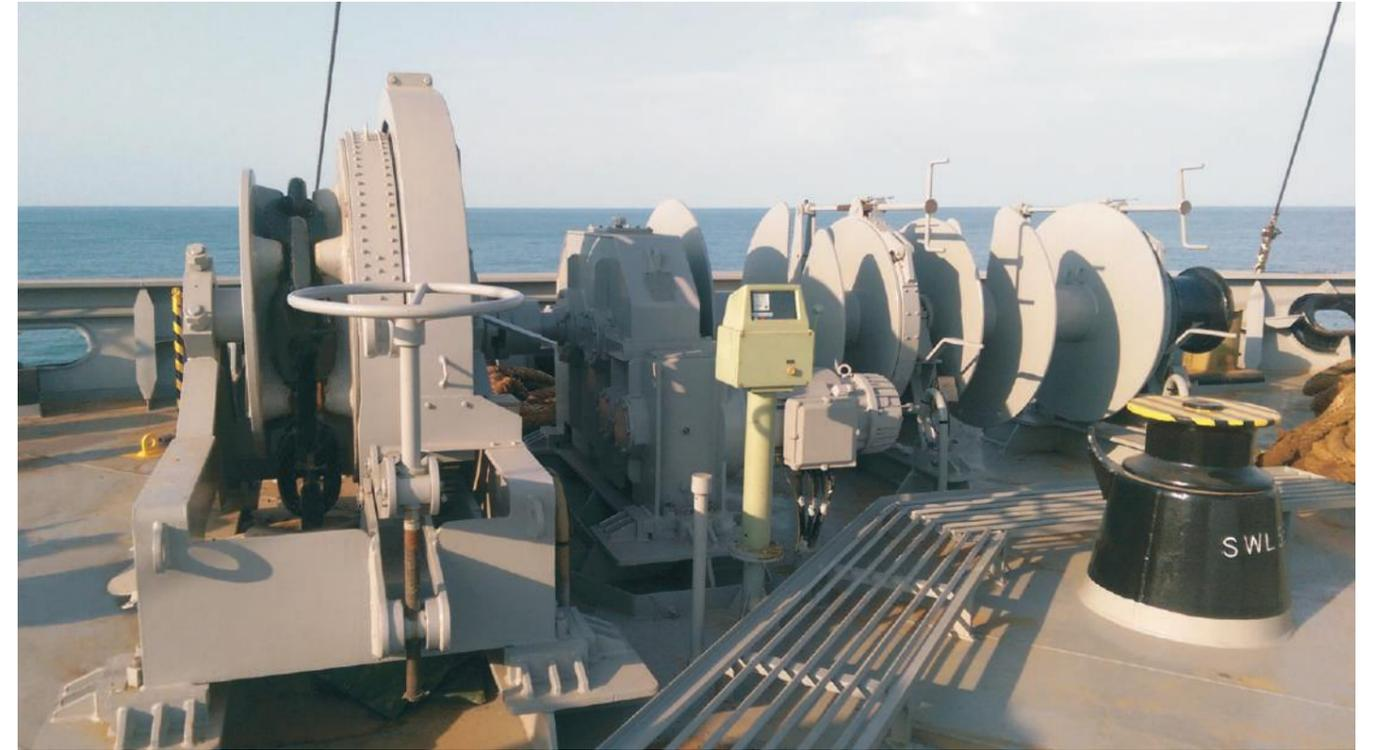
38800DWT散货船用Φ68电动锚机
