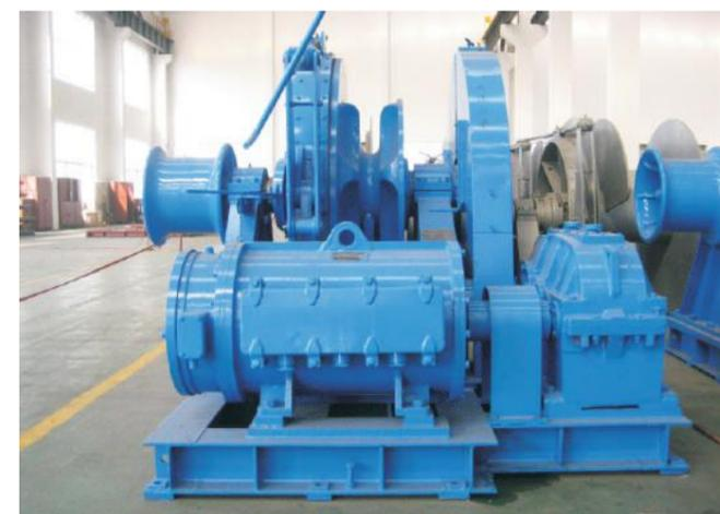
绞吸式挖泥船用Φ46电动起锚机
